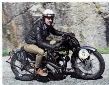
▲ Carbu double cuve, culasse et arbre à cames de 500, boîte de BSA... la 350 OHV3 moteur MAG de François Chatelus était préparée pour les courses de côte à l'époque.
