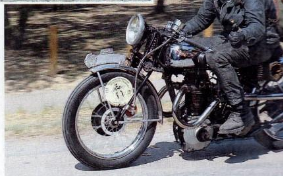
▲ Carbu double cuve, culasse et arbre à cames de 500, boîte de BSA... la 350 OHV3 moteur MAG de François Chatelus était préparée pour les courses de côte à l'époque.
